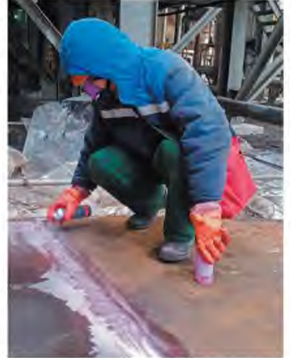
Алексей Невёдов исследует сварные соединения капиллярным методом
